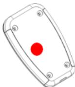
Se il tuo strumento si blocca (non risponde ai pulsanti), collega il dispositivo al computer con il cavo USB e premi il pulsante di ripristino con un ago nel foro sul retro dello strumento (mantenendo l'USB collegato).
